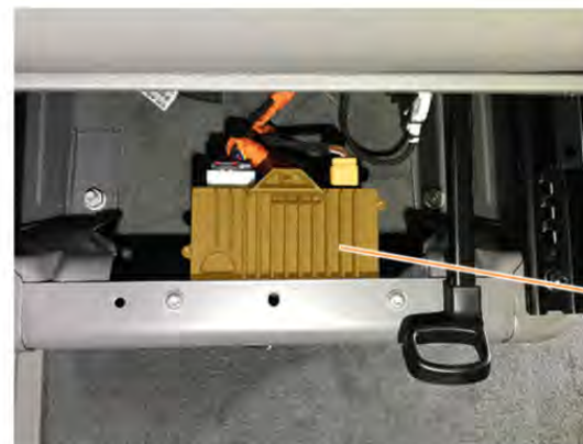
Onduleur dans le caisson de siège droit
